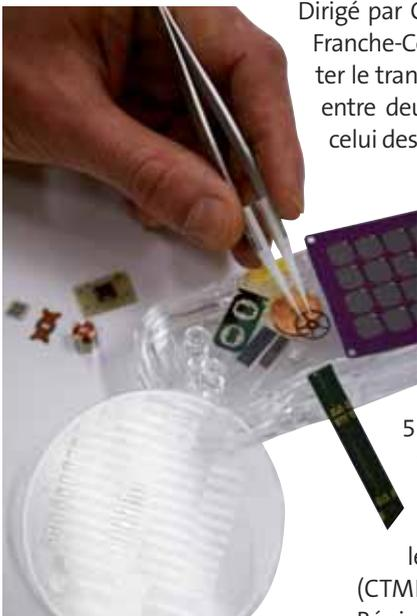
Pièces et systèmes micro-mécaniques réalisés par technologie salle blanche
