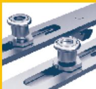
○ Les 6 verrous sont munis d'un galet à tête champignon et d'une gâche de sécurité composée d'une base en zamak recevant une coquille en acier traité.
