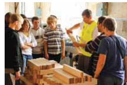
La technique de l'aboutage écologique (assemblage avec une colle à l'eau) parfaitement maîtrisée par l'entreprise Mounié.
