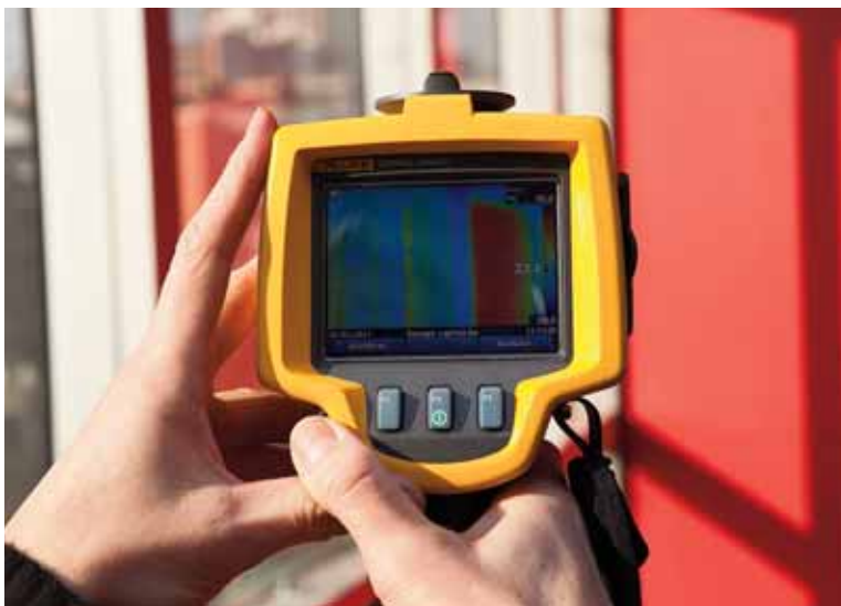
Caméra thermique (à gauche) et relevé de température (à droite) permettent d'analyser les points faibles du bâtiment.
