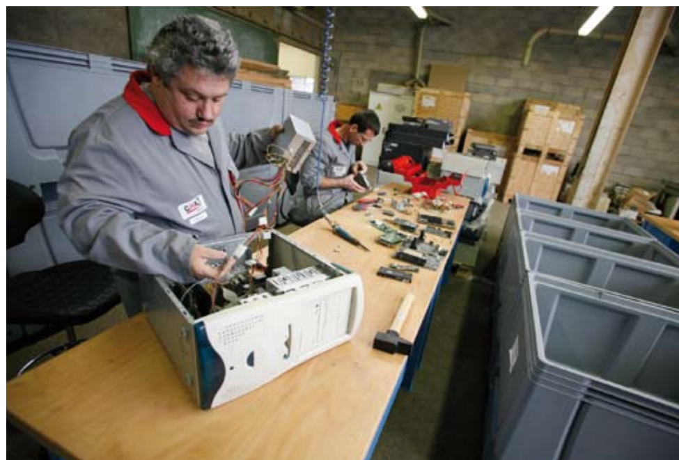
LES PREMIERS "DESOSSES" D'ORDINATEURS ONT COMMENCÉ.
