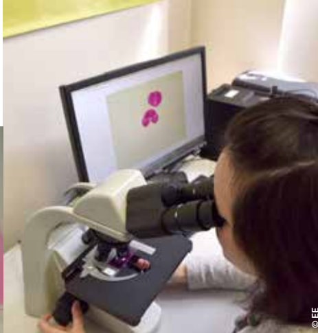
À la différence des autres polluants de l'air, l'analyse des pollens ne peut se faire automatiquement via des appareils. L'identification et le comptage se font au laboratoire, par observations au moyen d'un microscope.
