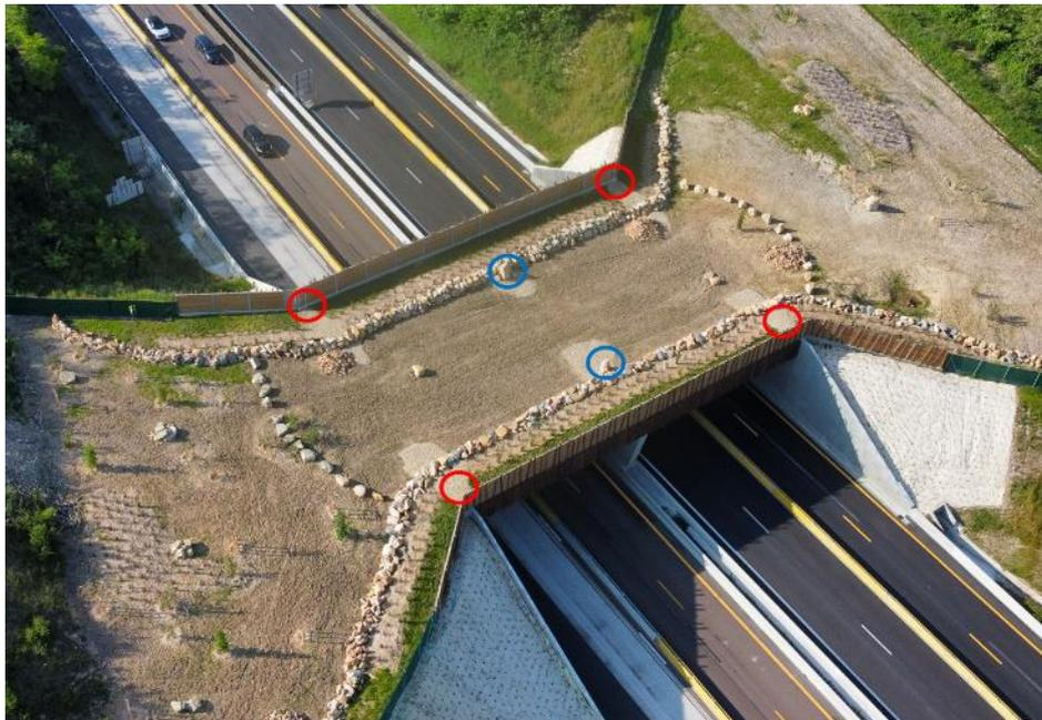
*Figure 2. Zones prévues pour la pose des appareils photographiques sur un exemple d'ouvrage représentées par les ellipses bleues pour les stèles et par des ellipses rouges pour les palissades.*
