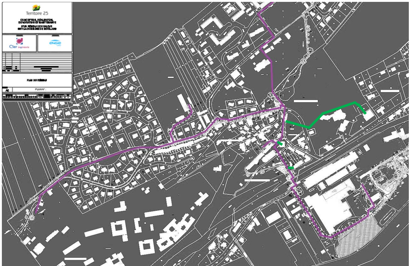
Figure 3: Plan du réseau de Chaleur Novillars (en mauve l'existant, en vert le projet d'extension 2024-2025)
